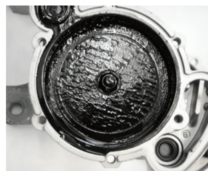
Fig. 3: A borra de óleo na bomba de vácuo do VW Transporter provoca ruídos de vibração
